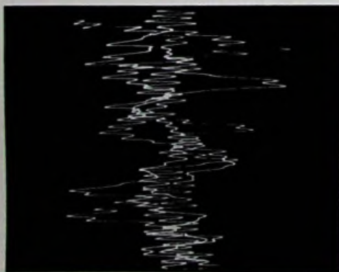
Afb. 5. Oscillogram van een audiosignaal. De tijdbasis heeft een frequentie van 50 Hz, de sluitertijd van de camera was 1/25s , zodat 2 oscillogrammen werden vastgelegd.
